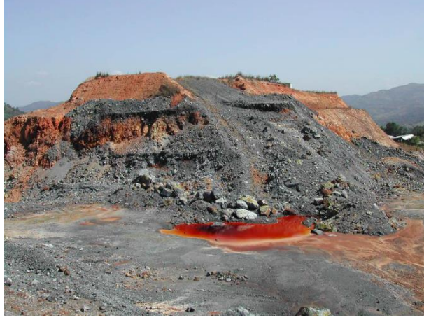
Şekil 10. Fiziksel ve kimyasal (AKD başlamış) stabilitesini yitirmiş bir pasa yığını (JMO, 2017).
